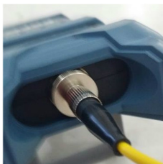
Gambar 3. 14 Connector yang Terpasang Pada Adapter OPM
