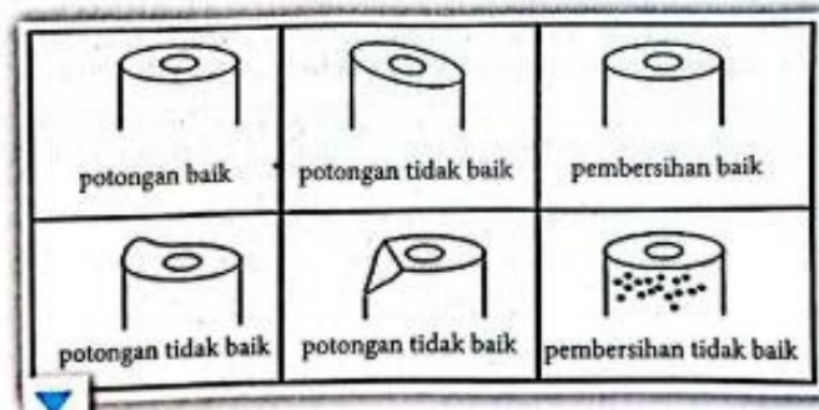
Gambar 3. 26 Hasil Pemotongan Serat Optik
